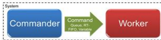
Рисунок 3.16. Вы можете передать команду в LabVIEW различными способами, включая буферы реального времени, очереди или переменные общего доступа Commander - Начальник, Worker - Исполнитель, Command – команда, Queue -очередь , RT-FIFO – буфер FIFO реального времени, Variable – переменная общего доступа.
