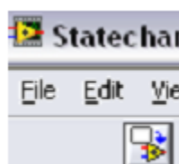
Рисунок 2.34. Щелкните по иконке в верхнем левом углу, чтобы LabVIEW сгенерировал код для диаграммы состояний
