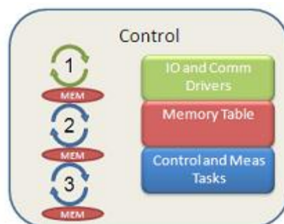
Рисунок 2.2. Три главных состояния контроллера базовой архитектуры Control – управление, IO and Comm Drivers – драйвера ввода-вывода и коммуникаций, Memory Table – таблица памяти, Control/Meas Tasks – задачи управления и измерения, MEM – память
