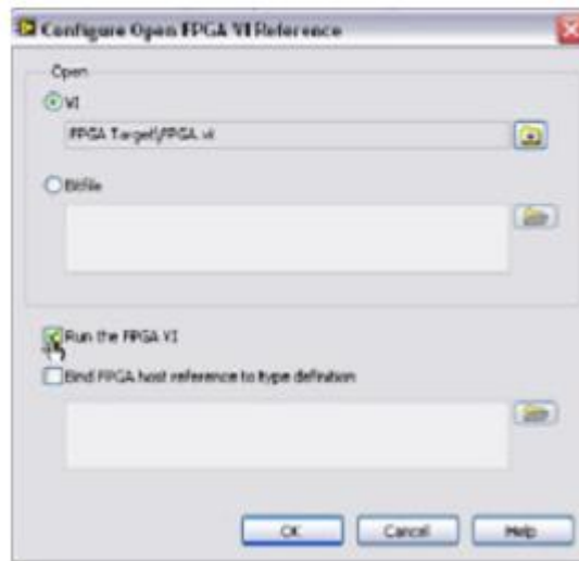
Рисунок 6.12. В диалоге конфигурирования открытия ссылки на FPGA вы можете выбрать VI или битовый файл и настроить его запуск при вызове
