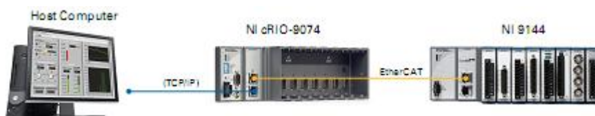
Рисунок 5.9. Для конфигурирования системы с детерминированным Ethernet подключите порт 1 контроллера cRIO-9074 к хост-компьютеру, а порт 2 – к шасси NI 9144
