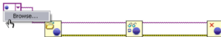
Рисунок 3.29. Программное чтение и запись в сетевые переменные или переменные ввода-вывода
