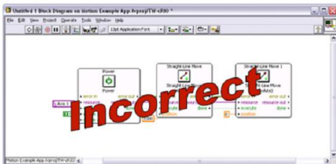
Рисунок 5.37. Пример неправильного программирования движения с использованием функциональных блоков
