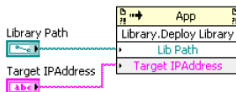
Рисунок 8.17. Вы можете программно развертывать библиотеки в целевых устройствах реального времени, используя узел Invoke Node на персональном компьютере
