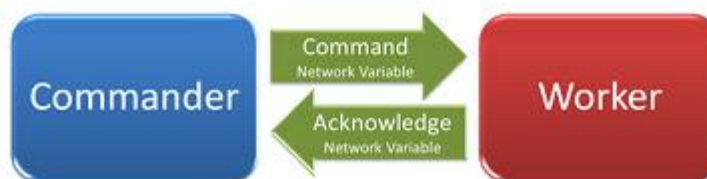
Рисунок 4.32. Упрощенная командная архитектура с квитированием на основе сетевых переменных Commander - Начальник, Worker - Исполнитель, Command – команда, Network Variable – сетевая переменная, Acknowledge – подтверждение приема
