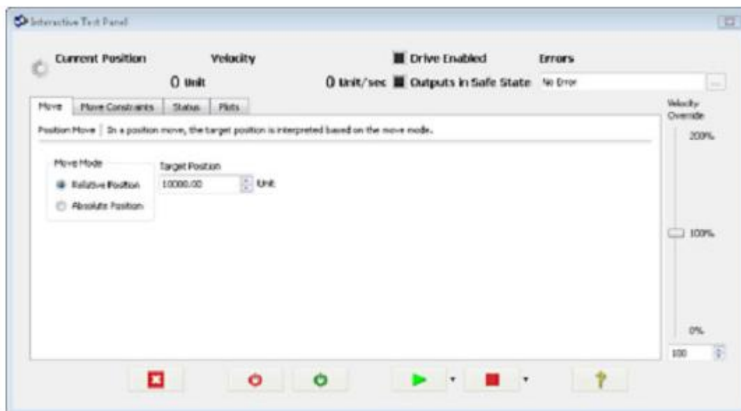
Рисунок 5.34. С помощью интерактивных тестовых панелей вы можете проверить правильность конфигурирования системы управления движением до разработки кода
