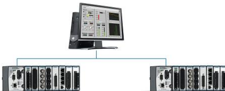
Рисунок 5.1. Простейший способ добавления еще одной системы CompactRIO в качестве подсистемы ввода-вывода через Ethernet предполагает подключение двух систем CompactRIO к одной сети
