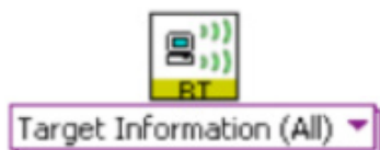
Рисунок 8.22. С помощью VI из палитры RT Utility можно программно конфигурировать контроллер и создать образ для конфигурирования
