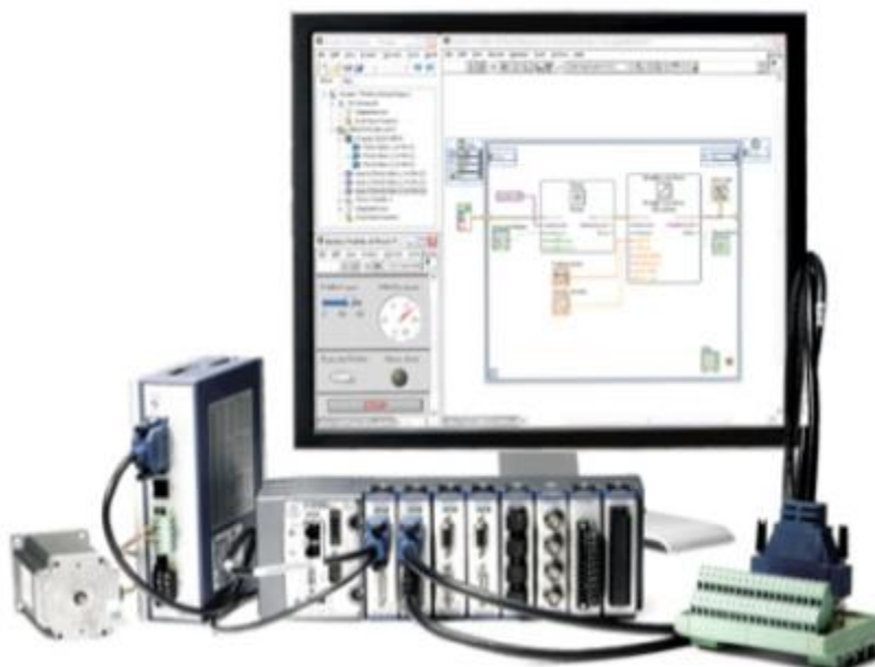
Рисунок 5.31. Выбор из нескольких вариантов для простого подключения модулей NI 951x непосредственно к приводу
