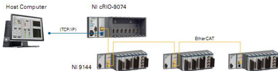
Рисунок 5.7. Архитектура аппаратных средств CompactRIO расширяет критические по времени системы с использованием детерминированного Ethernet и шасси NI 9144
