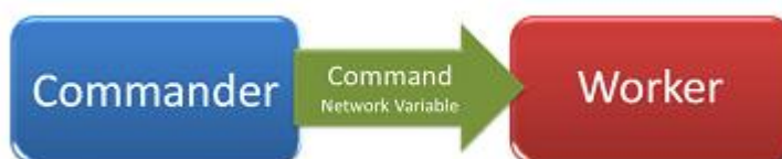
Рисунок 4.13. Простая командная архитектура с использованием сетевых переменных Commander - Начальник, Worker - Исполнитель, Command – команда, Network Variable –сетевая переменная
