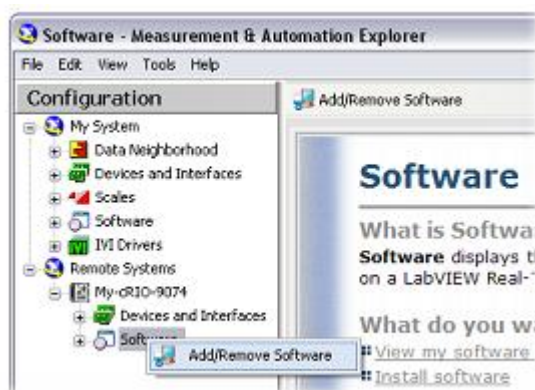
Рисунок 5.10. Установка необходимого ПО в Measurement & Automation Explorer
