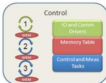
Рисунок 3.9. Управляющая программа может содержать несколько задач, которые выполняются параллельно и обмениваются данными с табличной памятью
